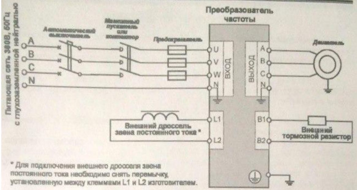
а) – подключение преобразователя в сетях с глухозаземленной нейтралью
